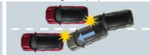
Sem sistema de travagem múltipla após colisão
