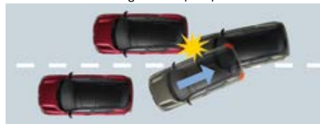
Com sistema de travagem múltipla após colisão
